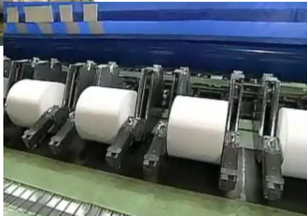
幅1m、重さ1トンのロールが完成しました。
