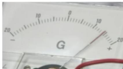
銅が電子を出して電子が移動している、
